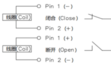
接线图 (单线圈)
